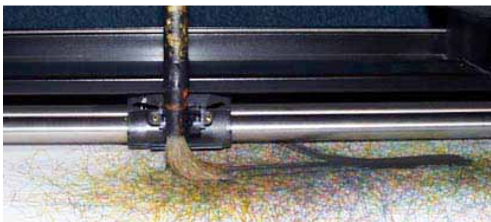
Detalle del plotter utilizado por Verostko, vemos la adaptación de la máquina con un pincel oriental dirigido a través del código utilizado por el artista. (1987)
